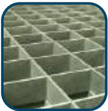
**HONEYCOMB HMR** adalah sebuah material isian/core bagian dalam pintu yang terbuat dari potongan HMR 3mm yang disusun membentuk kotak kecil yang berfungsi untuk menambah kekuatan pada pintu sehingga pintu menjadi lebih presisi dan tahan terhadap benturan.
