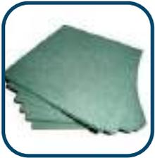
**HMR Board** adalah material yang di buat dengan memecahkan serpihan kayu menja diserat kayu lalu menggabungkan serat kayu dengan lilin dan pengikat resin membentuk papan dengan menerapkan suhu bertekanan tinggi. HMR(High Moisture Resistance Board) diproduksi dengan resin khusus untuk meningkatkan ketahanan dengan air di lingkungan yang memiliki kelembapan tinggi.
